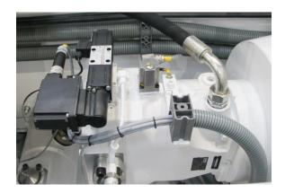
Um optimale Ergebnisse zu gewährleisten, kombiniert Stork immer ein frequenzgesteuerte Hauptmotor mit ein Servoventil an die Pumpe.
