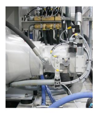
3. Frequenzgesteuerte Hauptmotor. Wenn die Maschine verschiedene Produkte in unterschiedlichen Zykluszeiten färtigt, kann es sinnvoll sein einen Frequenzumrichter einzusetzen um den Energieverbrauch im Leerlauf des Motors / der Pumpe zu reduzieren. Die Einsparungen können bis zu 7 kW / Std betragen.
